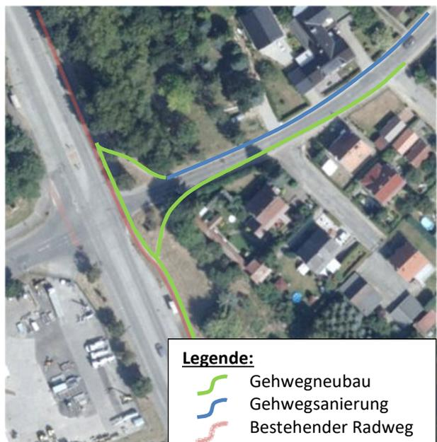
Abbildung 39: Ausbau Fußverkehrsführung am KP An der Fasanerie/Strelitzer Chaussee [4]
