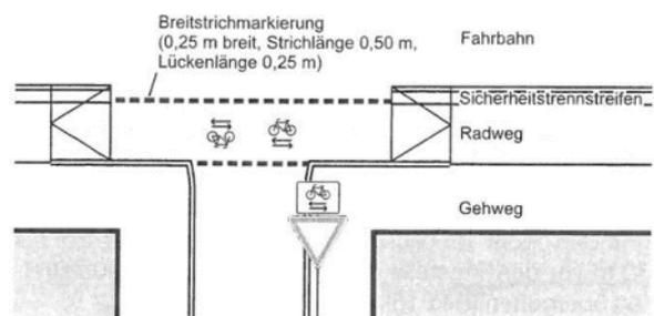
Abbildung 3: Radverkehrsfurt im Zuge eines Zweirichtungsradweges [3]
