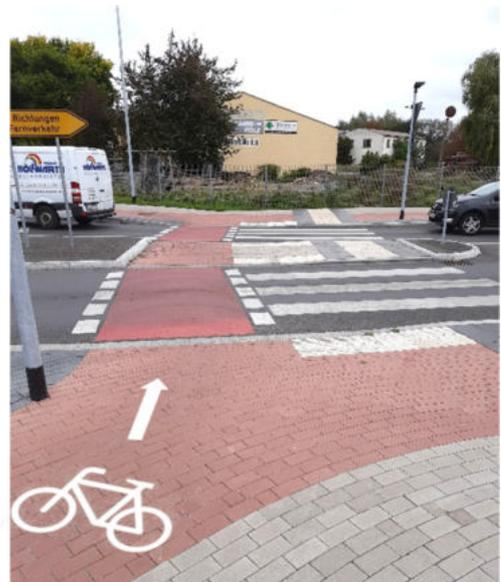
Abbildung 46: Piktogramm zur Umleitung des Radverkehrs am KV Woldegker Chaussee
