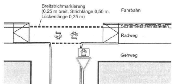
Abbildung 3: Radverkehrsfurt im Zuge eines Zweirichtungsradweges [3]
