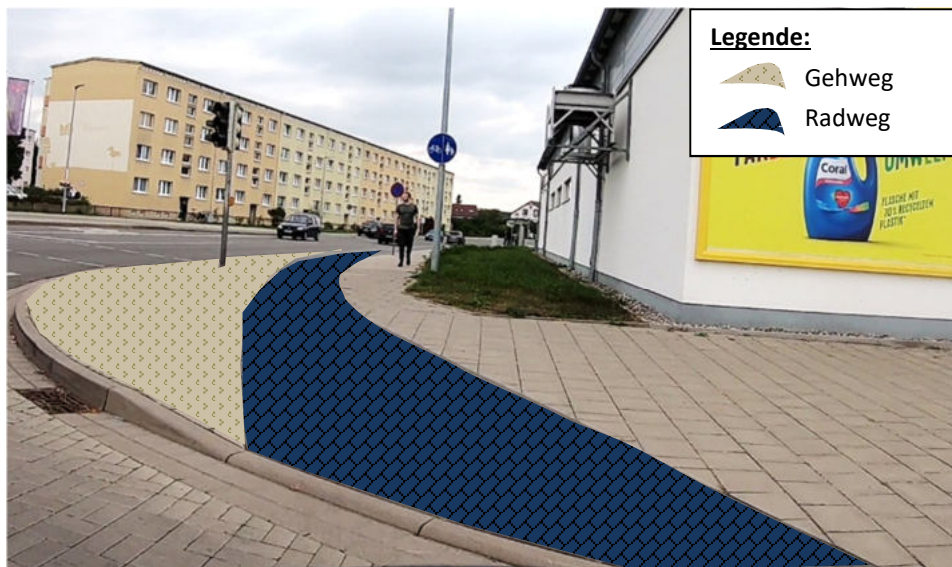
Abbildung 57: Verschwenk Radverkehrsführung Knotenpunkt Schulstr.
