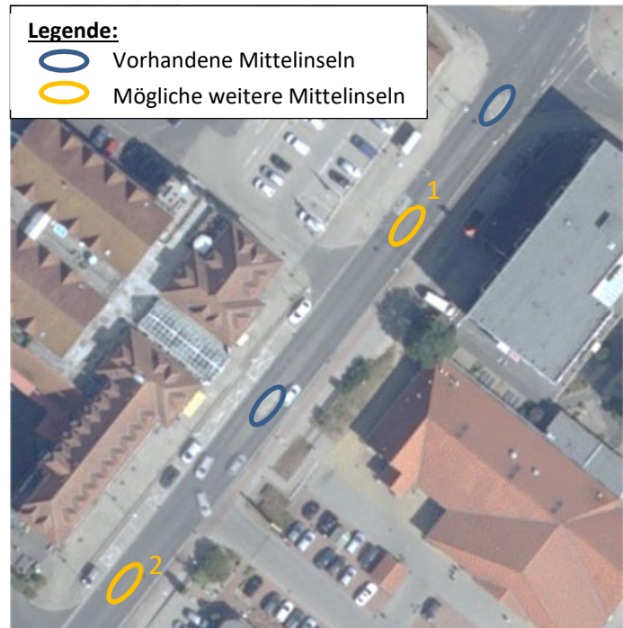
Abbildung 41: Variante weiterer Querungshilfen am Einkaufs- zentrum in der Karbe-Wagner-Str. [4] (Farbgebung dient nur zur Visualisierung)
